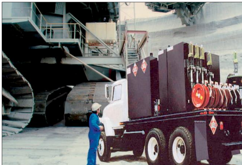
Camión de servicio Lubrovan con bombas hidráulicas PowerMaster III
